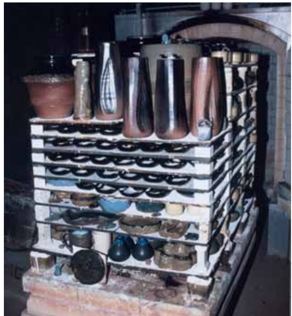
焼き上がったのぼり窯の内部
